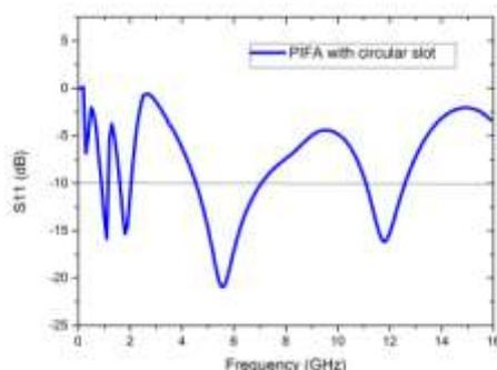
**Figure 8.** S11 parameter for circular slot PIFA
